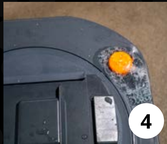
Skaka tanken ordentligt. Öppna avluftningsventilen.
