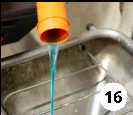
Töm ut innehållet och skölj ur tanken med rent vatten.
