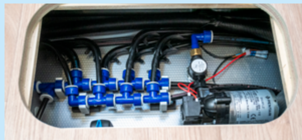
Tryckvattenpumpen måste tömmas inför vintern.
